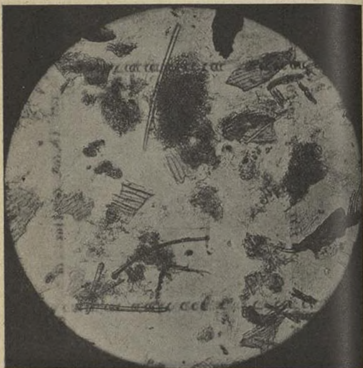
Fig. 27. — Mouture par meules. 70 pour 100 d'extraction. Quantité d'impuretés contenue dans 1 centigramme de farine.
