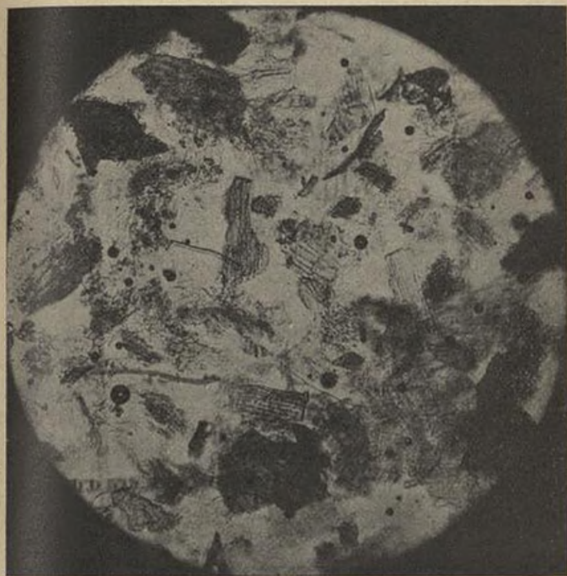
Fig. 28. — Mouture par meules. 78 pour 100 d'extraction. Quantité d'impuretés contenue dans 1 centigramme de farine.
