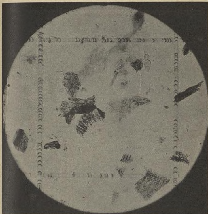
Fig. 24. — Mouture par cylindres. 70 pour 100 d'extraction. Quantité d'impuretés contenue dans 1 centigramme de farine.
