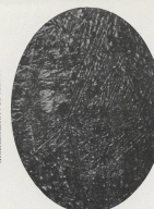
FIG. 11. — Miroir à 1000 fois. C'est une surface usinée. — Granulométrie : 10 divisions.
