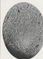
FIG. 4. — Miroir à 1000 fois. C'est une surface usinée. — Granulométrie : 10 divisions.
