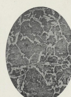
FIG. 23. — Miroir à 1000 fois. C'est une surface usinée. — Granulométrie : 10 divisions.
