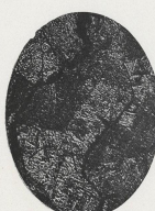
FIG. 19. — Miroir à 1000 fois. C'est une surface usinée. — Granulométrie : 10 divisions.
