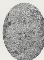
FIG. 7. — Miroir à 1000 fois. C'est une surface usinée. — Granulométrie : 10 divisions.
