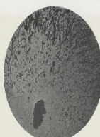
FIG. 13. — Miroir à 1000 fois. C'est une surface usinée. — Granulométrie : 10 divisions.
