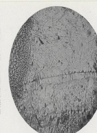
FIG. 17. — Miroir à 1000 fois. C'est une surface usinée. — Granulométrie : 10 divisions.
