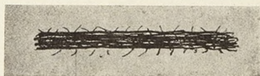
Fig. 11. — Fil tiré du tissu avant le foulage.
