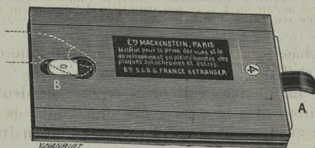
FIGURE 4. — Vue extérieure du châssis, côté de l'onglet. B onglet solidaire du taquet mobile C (fig. 3). — A volet avec sa tirette.
