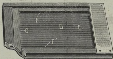
FIGURE 3. — Vue d'ensemble avec section du côté du taquet mobile, C taquet mobile. — E taquet fixe. — F, F' cartons protecteurs. — D fond du châssis.
