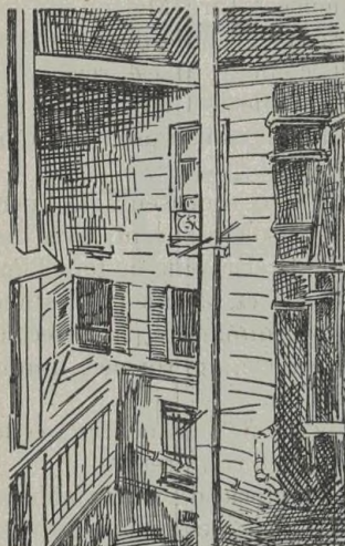
Croquis montrant les poteaux de béton armé de la cour, munis de leurs ancrs en attente, et passant en avant des vieux bâtiments.
