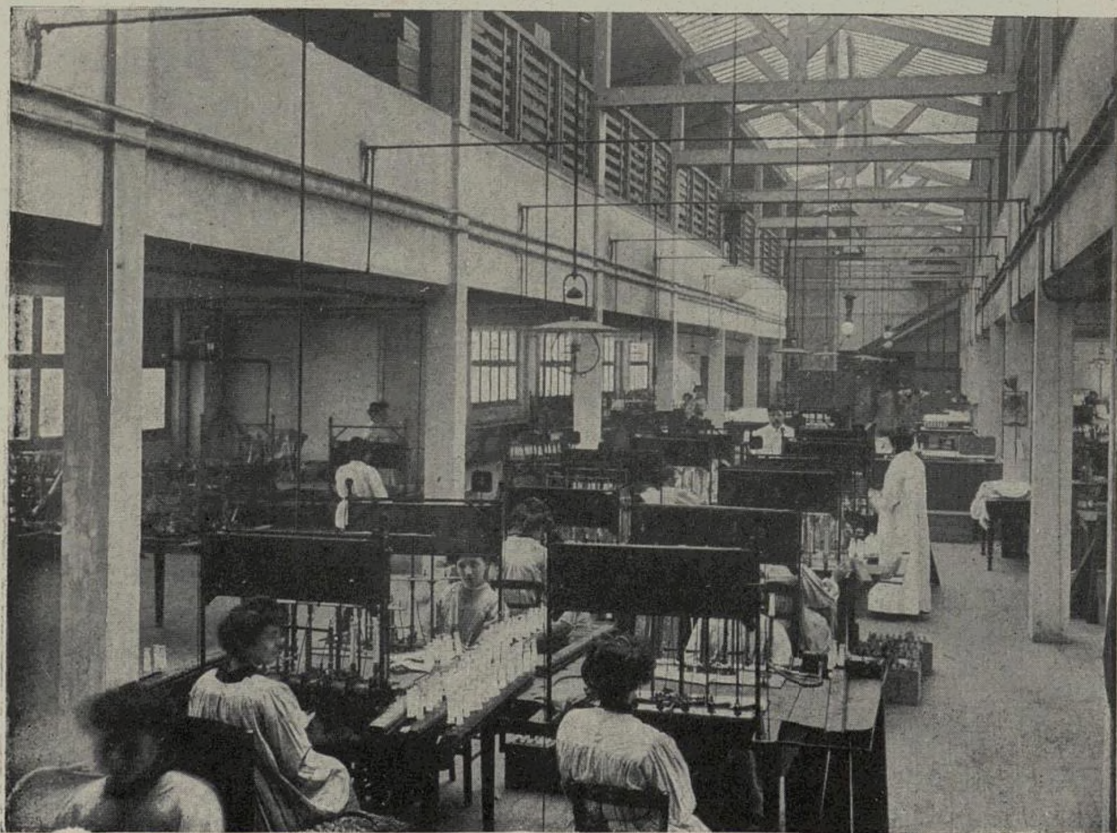
Fig. 23. — Salle de brûlage des manchons Plaissetty.
