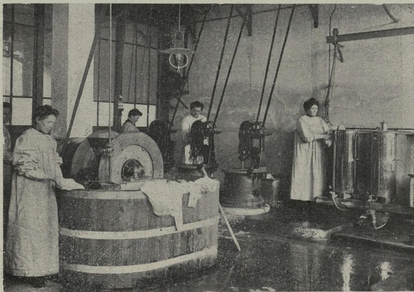
Fig. 11. — Traitement à l'ammoniaque, aux acides et lavage de la ramie. (Au premier plan à gauche de la figure la laveuse à ramie. — Au fond à gauche les turbines d'essorage et à droite les cuves pour le traitement aux alcalis).
