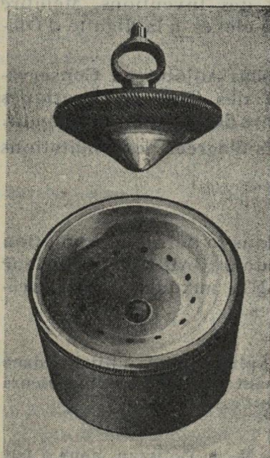
Fig. 1. Vues séparées du stator et du rotor de la turbine
