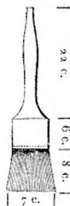
Ces brosses ont leurs soies étalées en forme de balai sur une épaisseur d'un centimètre pour la queue de morue de grande dimension, et d'un demi-centimètre pour celle de petite dimension. Le lien est en fer-blanc et doit serrer fortement les extrémités des soies.
