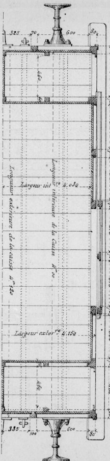
Fig. 6. Demi-plan, Coupe de la Caisse à 0 m 03 pour 1 er Mètre.
