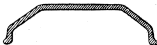
FIG. 63. Coupe transversale de la traverse Poids de la traverse : 58 kilos.
