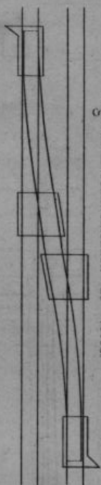
Fig. 270 — Changement à doubles rails mobiles.
