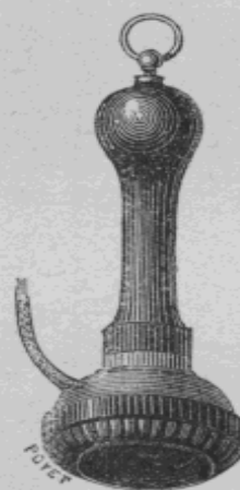
Fig. 14 et 15. — Téléphone Bell modifié par Maiche. (Coupe.) (Vue extérieure.)
