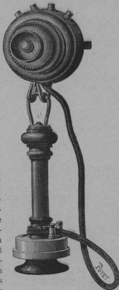
Fig. 385. — Téléphone domestique indéréglable, système Ader. Modèle à téléphone unique.
