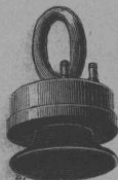
Fig. 12. — Récepteur Ader n° 3.
