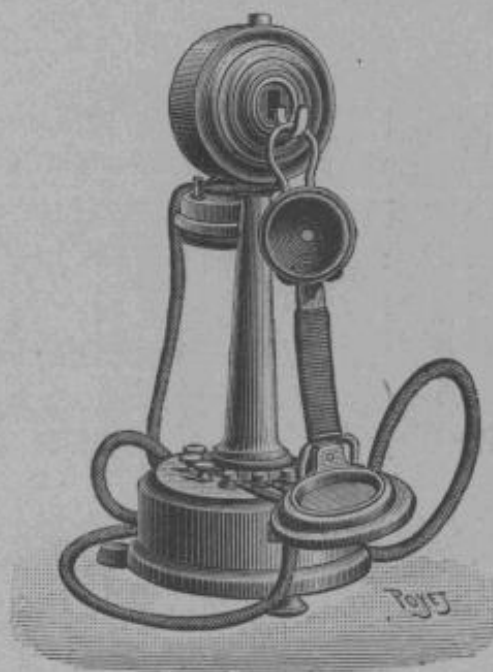
Fig. 109. — Transmetteur Berthon, type n° 10.
