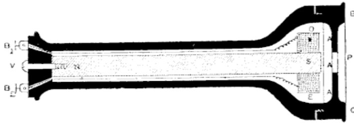
Fig. 10. — Téléphone Bell, modèle à muia ordinaire.
