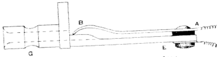
Fig. 145. — Jack à simple rupture, 1 er type.
