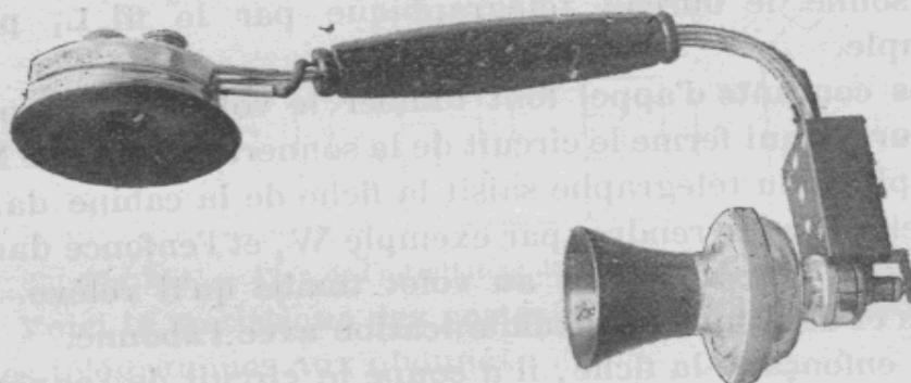
Fig 212. — Téléphone-montre et microphone Hunnings conjugués.
