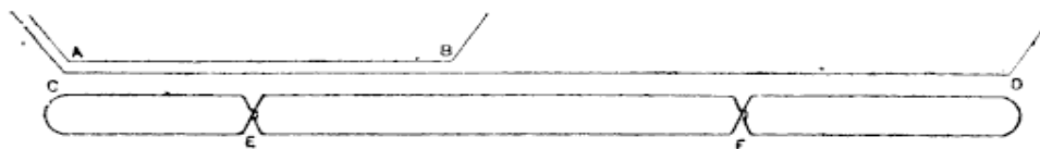
Fig. 101. — Annulation de l'induction sensible dans les circuits téléphoniques.
