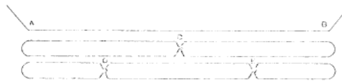
Fig. 102. — Permutation de fils les plus simples.
