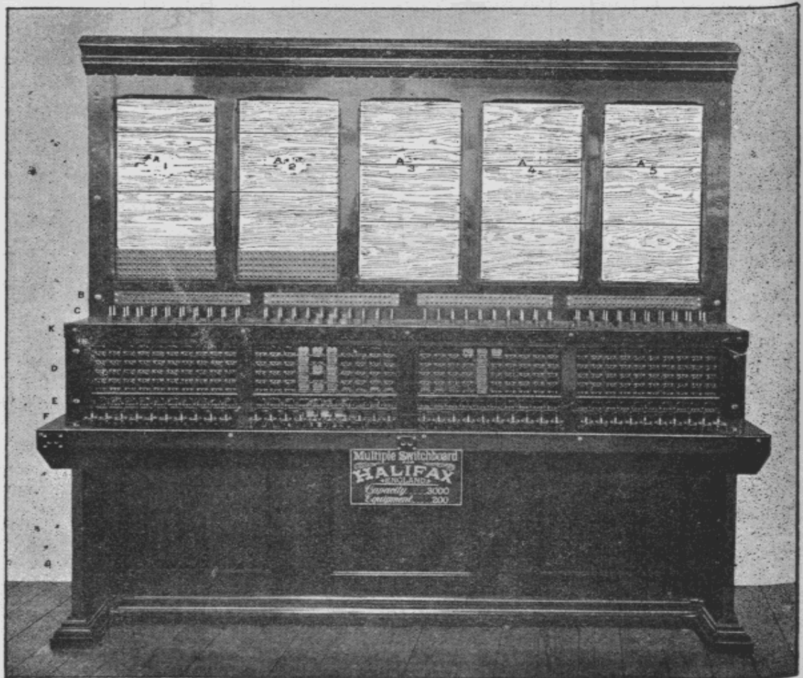
Fig. 175. — Vue d'une table multiple partielle (200 abonnés).
