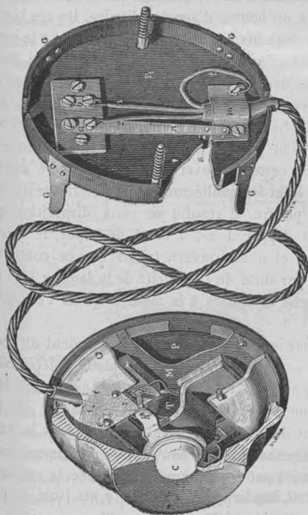
FIG. 55. — Détail des différentes pièces constituant le bouton-téléphone.
