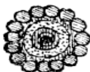
Câble de grande profondeur : Câble transatlantique 1857 (vraie grandeur)
