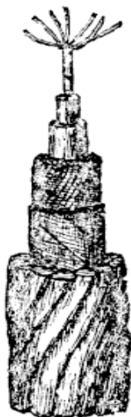
Câble de grande profondeur : Câble transatlantique 1857 (vraie grandeur)
