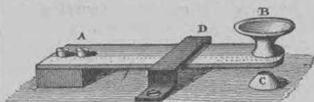
Fig. 75. — Clé d'appel du transmetteur Ader n° 1.
