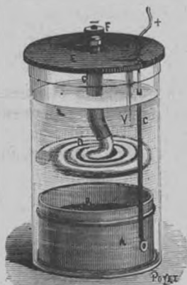
Fig. 71. — Pile de Lalande et Chaperon.
