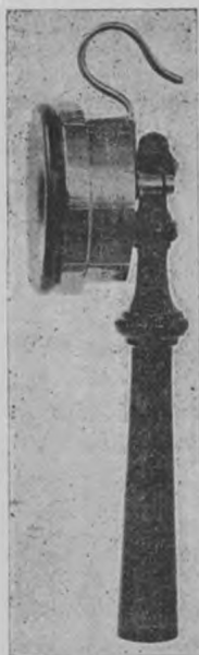
Fig. 17. — Récepteur Ducoussou à manche.
