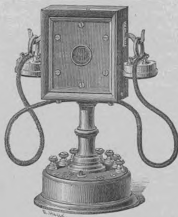
Fig. 75. — Transmetteur portatif Roulez.
