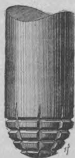
Fig. 54. — Charbon du microphone Guyomard et Rolland.
