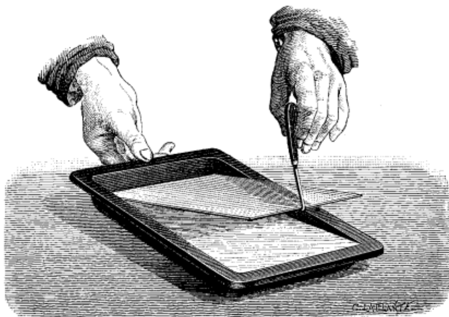
Fig. 22. — Immersion de la glace dans le bain d'argent.
