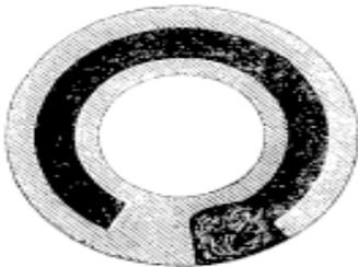
sur la face inférieure du disque, d'une feuille d'étain très-mince dont la fusion a lieu par l'effet de la combustion de la composition fusante. La chambre d'amorce est fermée à l'extérieur par une feuille d'étain de même espèce qui fond et disparaît sous l'action des gaz enflammés de la charge de tir. Le débouché du canal de la chambre à poudre
