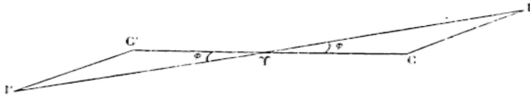
Mais si  $CC'$  est une barre horizontale égale à  $\frac{d}{2}$ , et que I et I' conduisent les deux lentilles L et L' du système supposé, l'angle micrométrique de la lunette variera évidemment suivant la loi nécessaire pour opérer la réduction à l'horizon.
