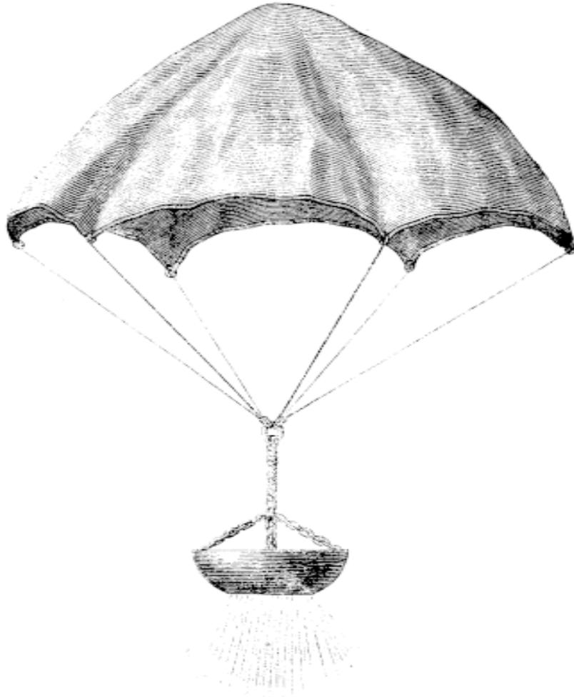
Le feu du papier salpêtré se communique à l'amorce de la composition éclairante, et par suite à cette composition elle-même. Le parachute se déploie et soutient la boîte éclairante : le jet de flamme de la composition s'échappe par l'ouverture
