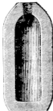
Leur vide intérieur ne présente rien de particulier. Leur lumière est filetée. Ils sont munis extérieurement, dans leur partie centrale, et sur les deux tiers environ de leur hauteur, de six rayures planes, disposées en hélice, et destinées à s'appuyer sur des rayures en hélice de même pas, tracées dans l'âme de la bouche à feu.
