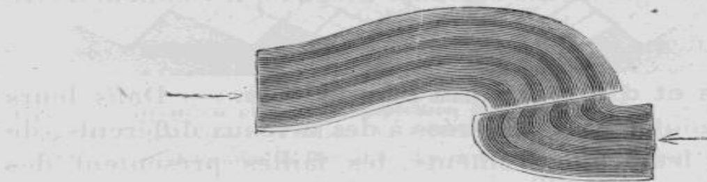
Fig. 4. — Prisme composé d'une série de couches de cire différemment colorées et soumises à des pressions indiquées par les flèches. Production d'une fracture avec glissement consécutive à l'inflexion.
