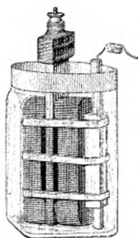
FIG. 5. — PILE LECLANCHÉ A PLAQUES MOBILES
