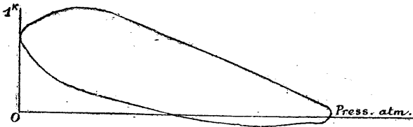
Fig. 6. — Diagramme d'une machine Bailey de un cheval : pression maxima, une atmosphère effective.
