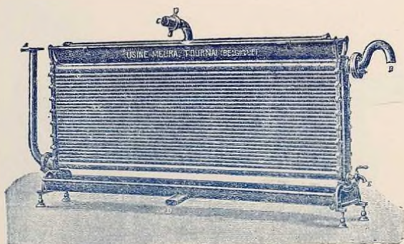
Réfrigérant à tubes ovoïdes et à contre courant simple
