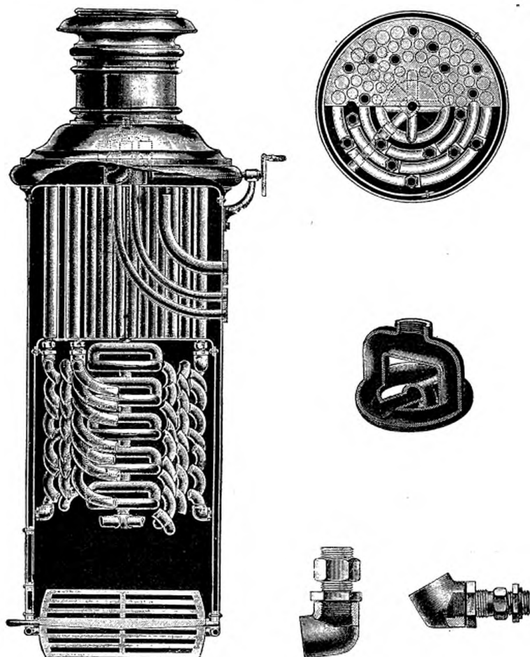
Fig. 569 à 573. — Chaudière tubulée Clapp. Coupe verticale. Plan-coupe. Détail du déflecteur et des raccords des tubes.
