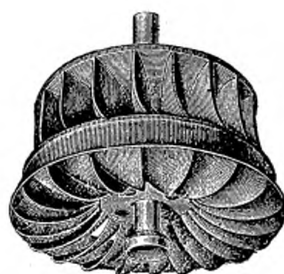
Fig. 474. — Turbine New American. Détail de la roue.
