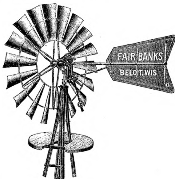
Fig. 359. — Moulin Fairbanks, à ailes d'acier galvanisé, régulateur à poids, transmission directe, roue tournant sur arbre fixe, avec réservoir de graissage dans les plateaux; portées sur Babbitt.
