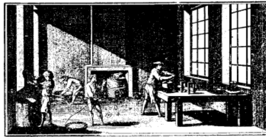
FABRICATION DES ÉPINGLES AU XVIII e SIÈCLE Étirage du laiton. — Décapage.
