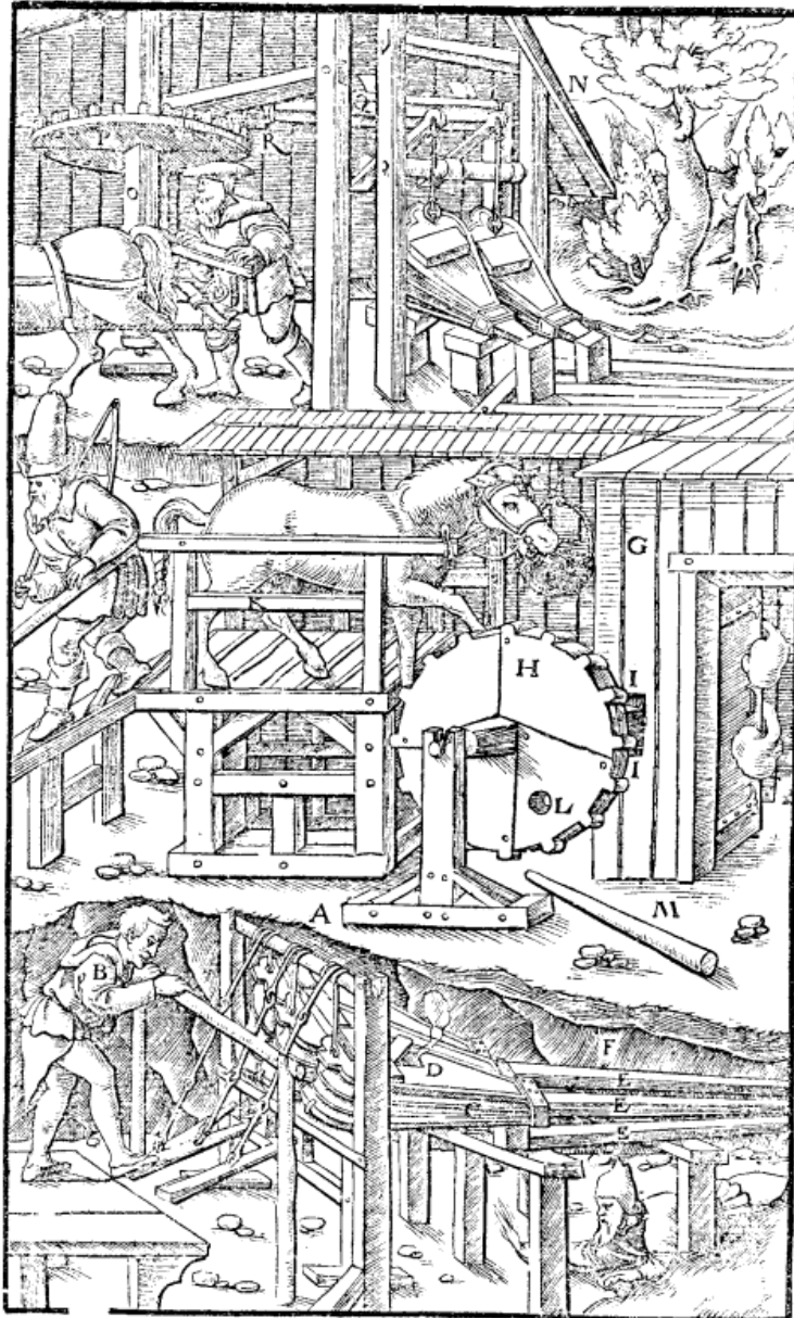
La ventilation au moyen âge, d'après Agricola.
