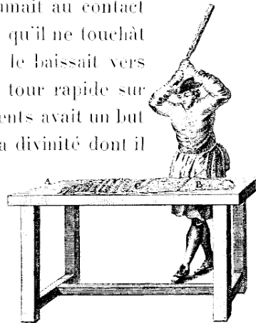
Fabrication des pipes. Préparation de la pâte. (Gravure extraite de l' Encyclopédie méthodique .)
