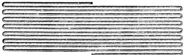
Fig. 153. — Serpentins réfrigérants pour cale de navires.
