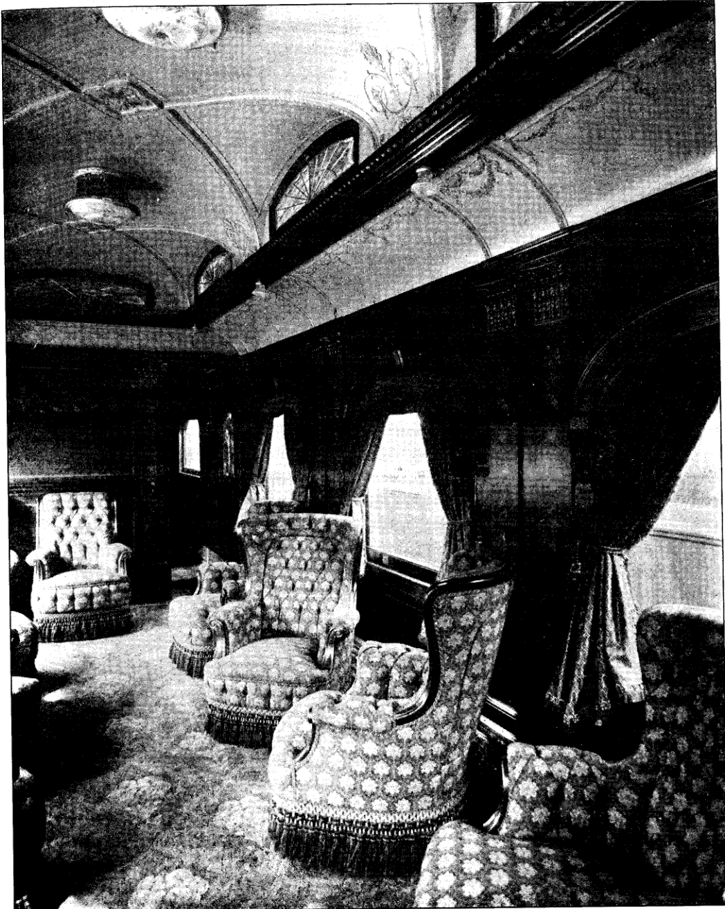
FIG. 8. — Voiture à fauteuils destinée aux petits trajets : les fauteuils sont pivotants et peuvent prendre toutes orientations.
