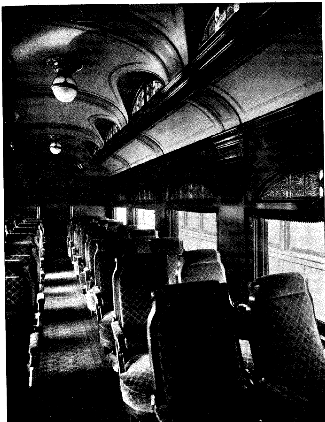
FIG. 7. — Voiture à fauteuils destinée aux petits trajets : les fauteuils sont pivotants et peuvent prendre toutes orientations.
