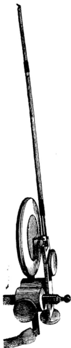
FIG. 41. — Levier du polygraphe articulé avec la membrane du tambour.
