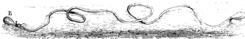
FIG. 35. — Schéma de la transmission des mouvements à distance.
