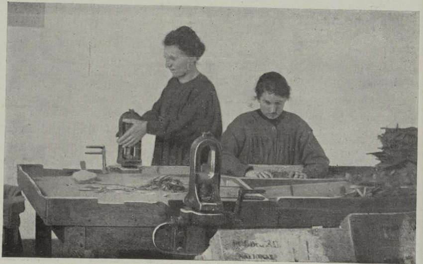
III. — La bottleuse égalise la botte dans la presse (troisième mouvement).
