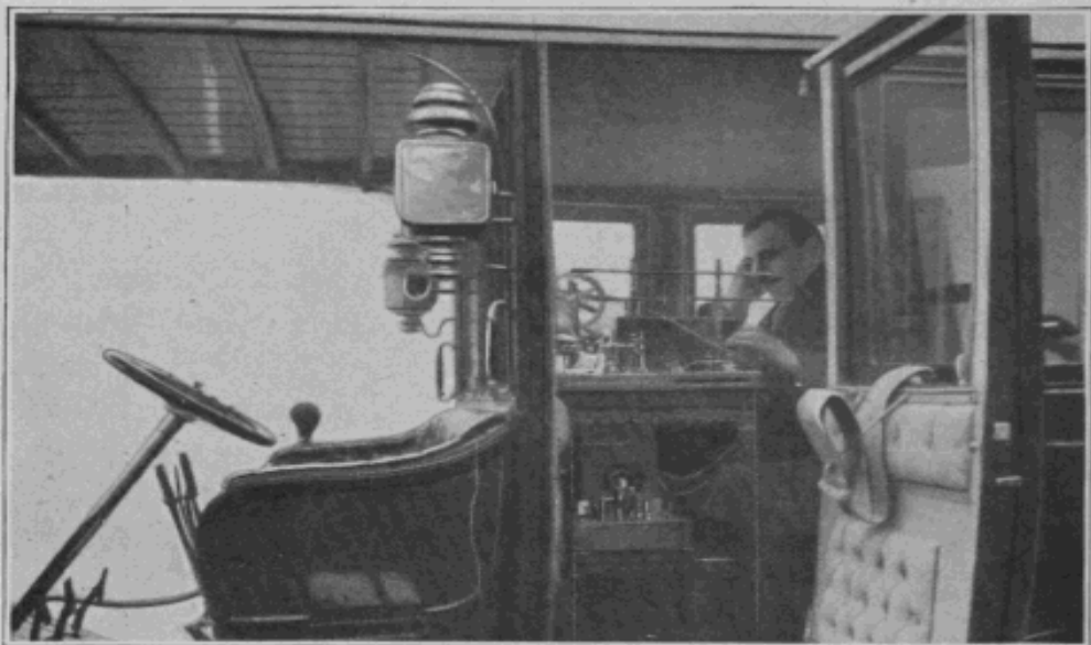
LA T. S. F. MILITAIRE Un poste de campagne : les appareils de réception et d'émission de T. S. F. à l'intérieur d'une automobile. (Cl. Branger.)
