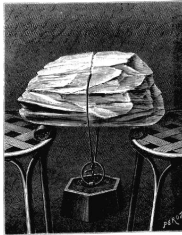
Fig. 5. Expérience sur la regelation de la glace.
