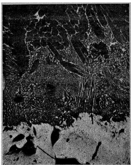
Fig. 19. — Eutectique de Zn 4 Cu et Zn 3 Cu.
