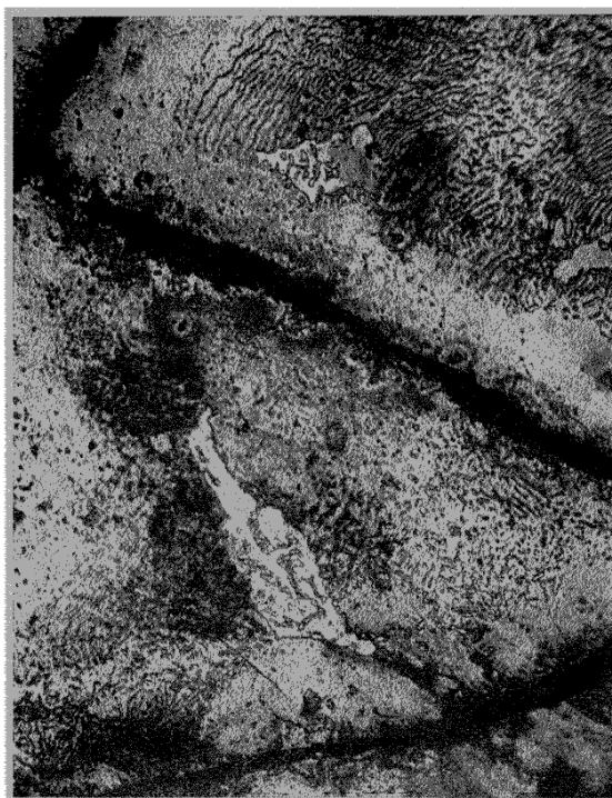
Fig. 4. — Fonte grise de bonne qualité (fig. 3) après recuit. Grossissement 660.
