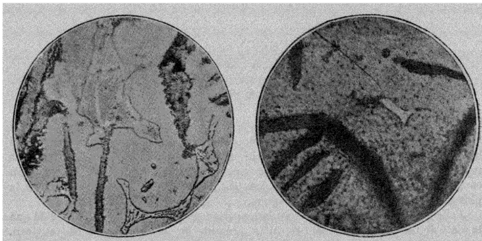
Fig. 14. — Fonte Cargo Fleet de Cleveland, n° 3, montrant des sections foncées de parcelles graphitiques, la structure concassée d'eutectique phosphoreux et la masse fondamentale de fer contenant du silicium et du manganèse. Grossissement : 200.
