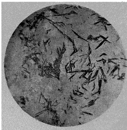
Fig. 25. — Acier recuit à 900° 0,250 C. 25 p. 100 Ni. Gr. 300 d.
