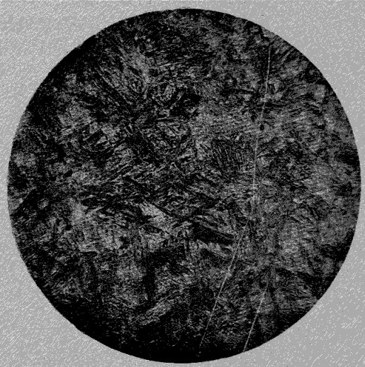
Fig. 20. — Acier trempé 0.250 C. 15 Ni. Gr. 300 d.
