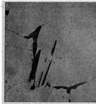
Phot. 22. — C = 0,134 Al = 3,05 Recuit pendant 4 h. à 1.200° La perlite ne s'est pas résolue. G = 200 d.
