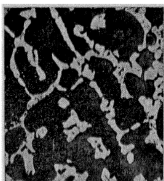
Phot. 14. — C = 0,247 Al = 15,97 Attaque à l'eau régale Perlite et cémentite. G = 200 d.
