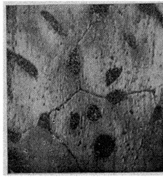
Phot. 23. — C = 0,168 Al = 5,07 Recuit à 1.200° pendant 4 heures La perlite est restée granulaire. G = 200 d.
