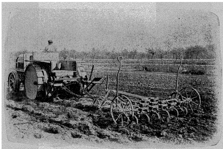
Fig. 17. — Tracteur-treuil en traction directe sur un piocheur-vibreur.
