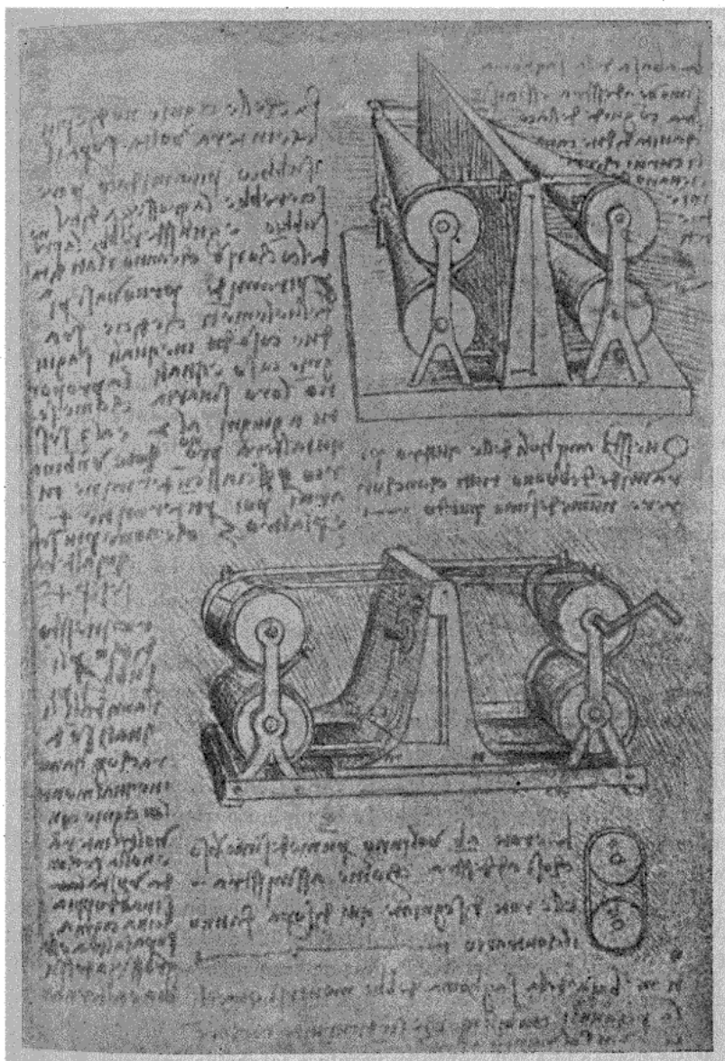
Fig. 61. — Courroies, sangles (Léonard de Vinci, 1500).
