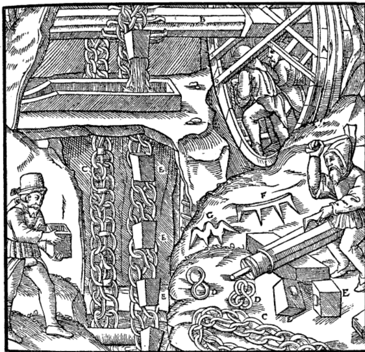
Fig. 54. — Crochets droits et crochets à trois bosses, implantés sur les arbres moteurs pour empêcher le glissement de la chaîne de transmission (Agricola, 1556).
