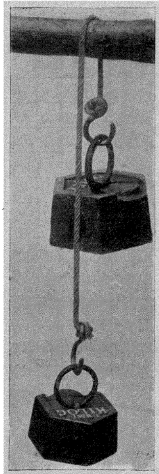
Fig. 30. — Équilibre statique de deux poids différents sur un levier funiculaire du premier genre.
