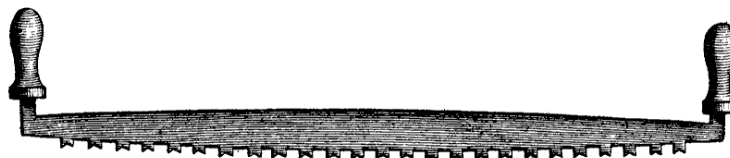
Fig. 141. — Scie de charpentier, à double action ( Encyclopédie , 1768).
