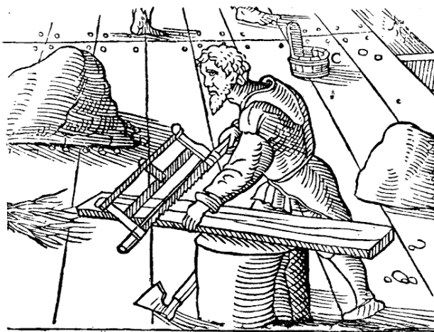
Fig. 19. — La scie au XVI e siècle (AGRICOLA, De re metallica , 1536).
