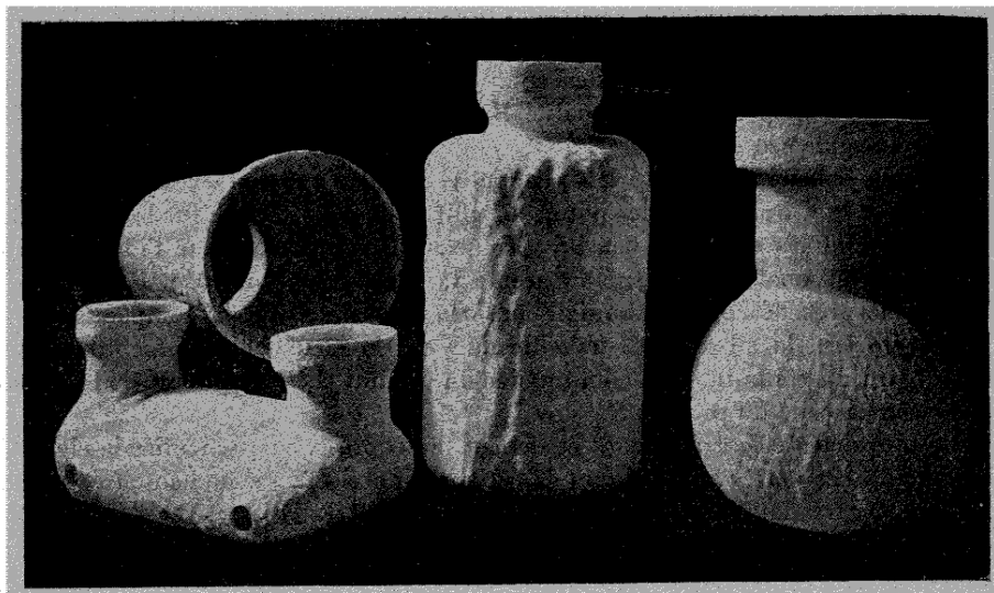
Fig. 8. — Vue de quelques pièces de grandes dimensions : tourie de 200 litres; ballon de 1.500 litres; cellarius; tuyau de 400 mm de diamètre.
