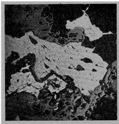
Fig. 7. — Minerai complexe plombzincifère de Ceilhes (Hérault). — Galène en plages blanches montrant les figures triangulaires dues à l'arrachement de petites lamelles de clivage pendant le polissage. Le mispickel forme une plage blanche à fort relief vers le bas de la photographie. La blende forme des plages grises, et la gangue des plages gris foncé presque noires. (Grossissement 56).
