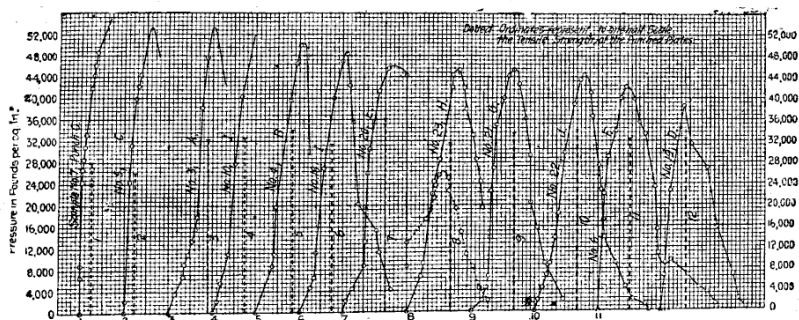
Fig. 212. — Diagrammes du travail dépensé dans les essais de poinçonnage de M. ALLEN.
