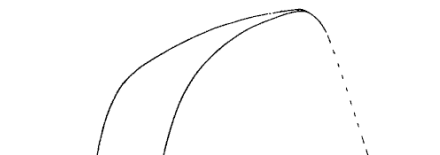
Fig. 74. — Diagrammes superposés d'un cisaillement à plat et d'un cisaillement à champ, d'une même barre de fer de 30 \times 20 mm.
