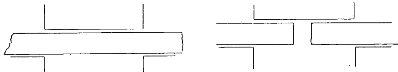
Fig. 97 et 98. — Schémas du dispositif imaginé pour effectuer un cisaillement double et un cisaillement égal à deux cisaillements simples.
