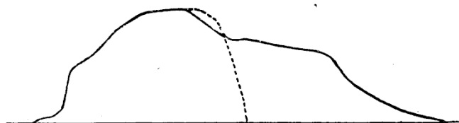
Fig. 229. — Diagramme du travail dépensé avec le poinçon en double hélice : 1° En trait continu, pour produire un trou cylindrique; 2° En trait pointillé, pour produire un trou conique.
