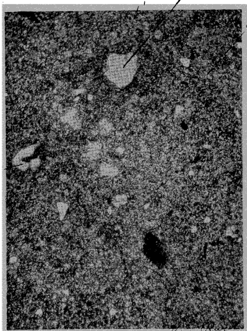
Fig. 3. — Mélange à tuile de Marseille (examen au microscope polarisant; G = 80 d).
