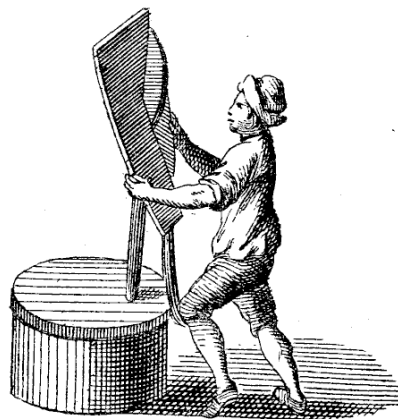
Fig. 7. — Cisaille à longues branches, actionnée par le genou de l'ouvrier.
