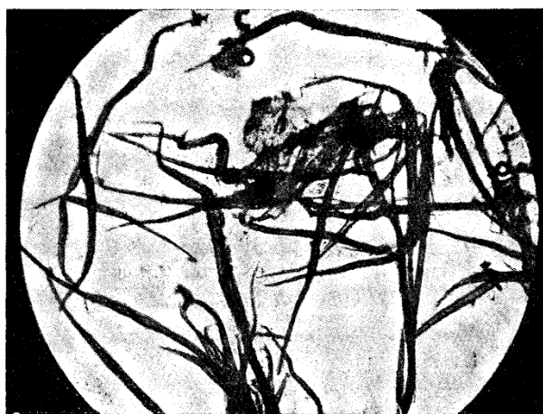
Fig. 6. — Fibres de ramie.
