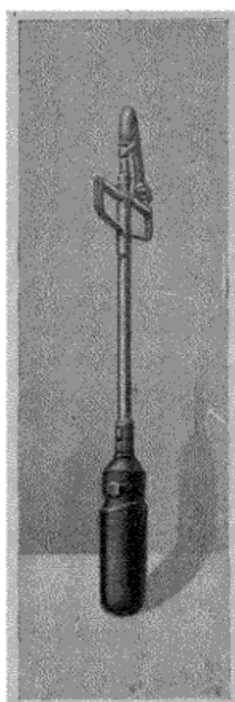
Fig. 5. Pervibrateur à main.
