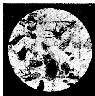
FIG. 9. — Mouture par meules métalliques. — 70 o/o d'extraction. — Quantité d'impuretés contenue dans 1 centigramme de farine.
