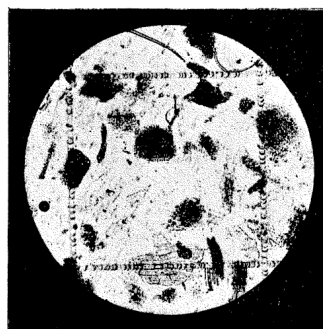
FIG. 8. — Mouture par meules métalliques. — 62 o/o d'extraction. — Quantité d'impuretés contenue dans 1 centigramme de farine.
