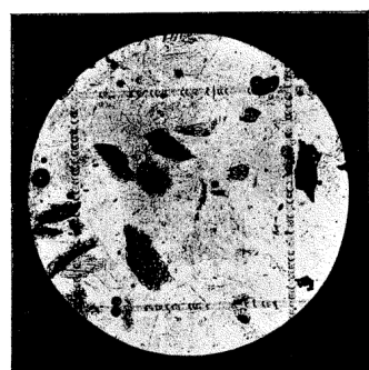
FIG. 7. — Mouture par cylindres. — 74 o/o d'extraction. — Quantité d'impuretés contenue dans 1 centigramme de farine.
