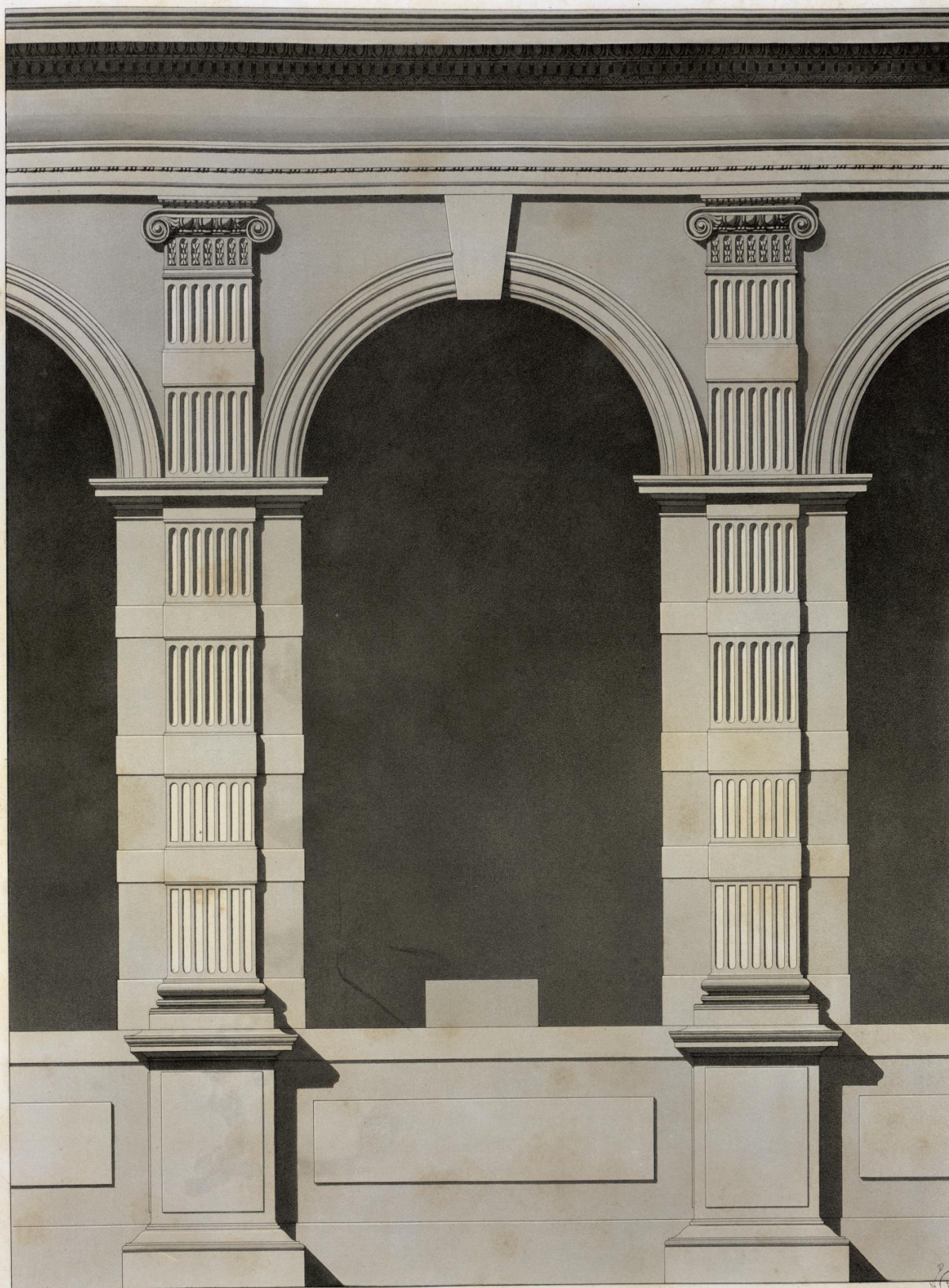
PORTIQUE DU REZ-DE-CHAUSSEE DU CHATEAU DES TUILERIES. Echelle de 0,04 pour mètre.
