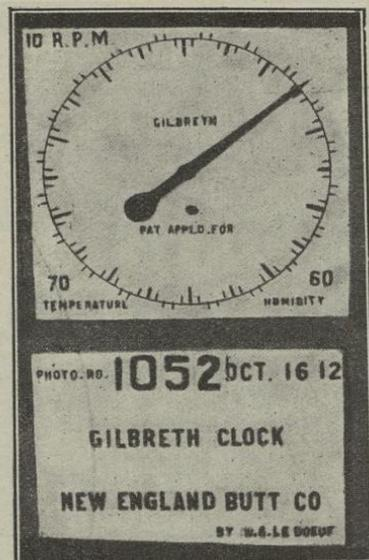
Fig. 2. — Horloge pour le chronométrage cinématographique
