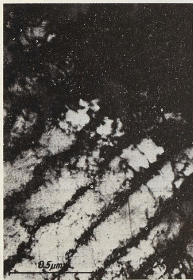
FIG. 19. — Micrographies électroniques d'échantillons de niobium recuits à 2 h à 1750 °C sous un vide de 10^{-7} torr, avant déformation (22) ; Haut : laminé de 14 % (formation d'une structure cellulaire) ; Bas : laminé de 62,5 % et plié plusieurs fois. Les parois de dislocations sont alignées parallèlement aux plans \{100\} .
