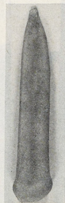
FIG. 4. — Dépôt électrolytique de cobalt (G × 1)
