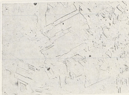
FIG. 7. — Cobalt de haute pureté recuit à 460° sous vide de 5.10^{-5} torr ( G \times 360 ).
