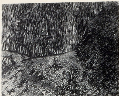
FIG. 13. — Variation des figures de Bitter avec l'orientation des grains sur le cobalt recuit ( G \times 200 ).
