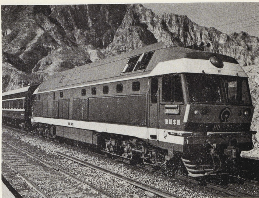
FIG. 24. — Locomotive diesel CC 3 650 chevaux, en service sur les chemins de fer chinois (document Alsthom).
