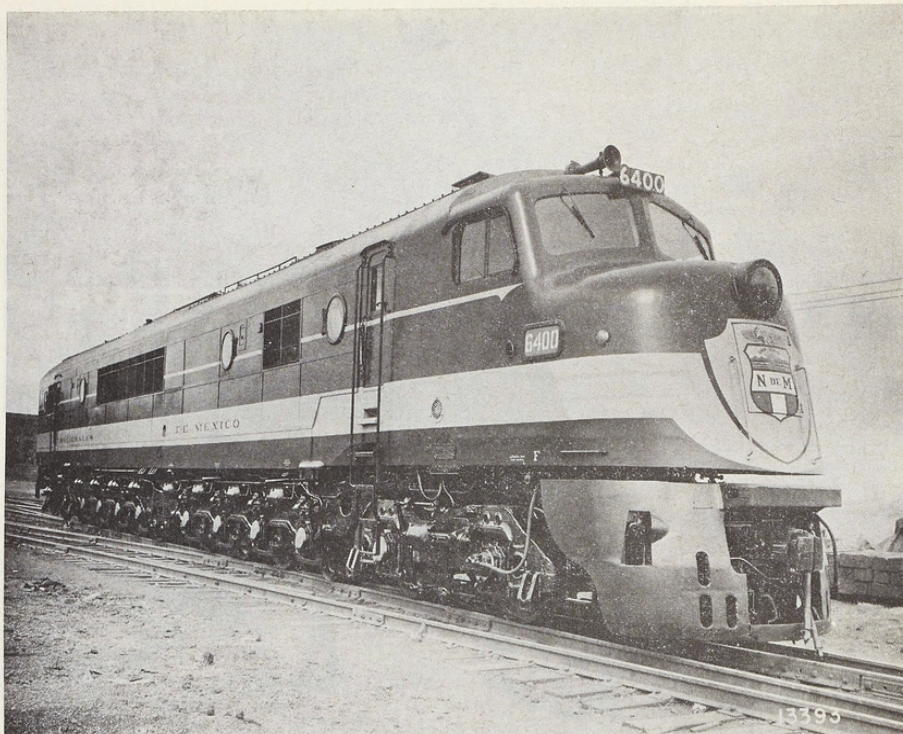
FIG. 20. — Locomotive 3 000 chevaux, type 2 DD 2, à 30 tonnes par essieu.
