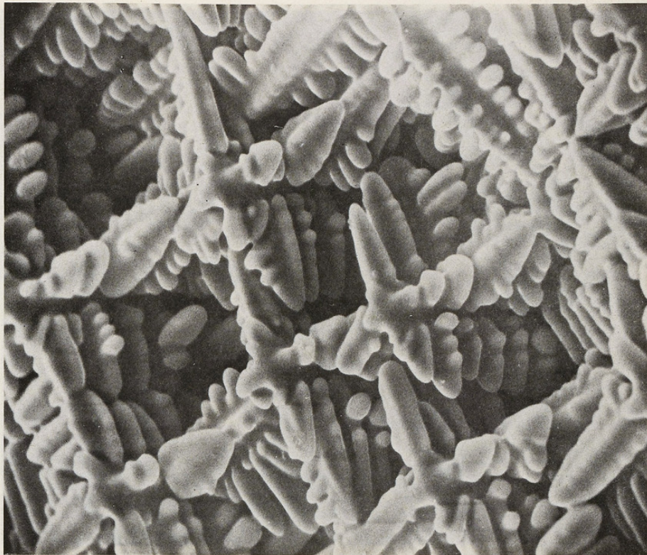
Fig. 11. — Cratère final d'une soudure par faisceau d'électrons, d'alliage à base de nickel à durcissement structural ; cliché microscope électronique à balayage, grandissement 1000.
