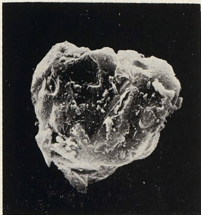
1. Grain de C_3S_{(L)} , n'ayant subi aucun traitement. G = 4\ 500 .
