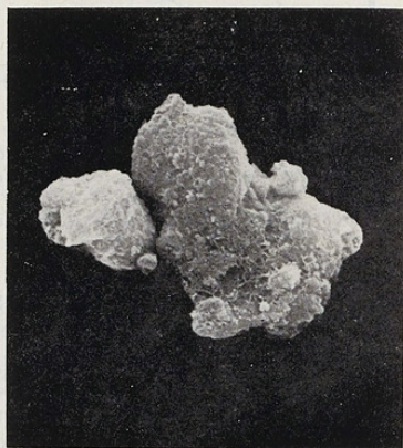
3. Echantillon de C_3S_{(L)} agité pendant 1 h 30 dans l'eau. G = 3750 .
